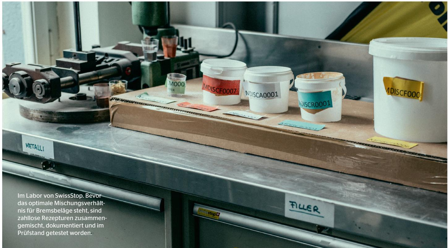
Im Labor von SwissStop. Bevor das optimale Mischungsverhältnis für Bremsbeläge steht, sind zahllose Rezepturen zusammengemischt, dokumentiert und im Prüfstand getestet worden.
